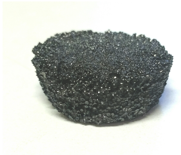
Şekil 10.17. Biyo-ziftten üretilen karbon köpük örneği
