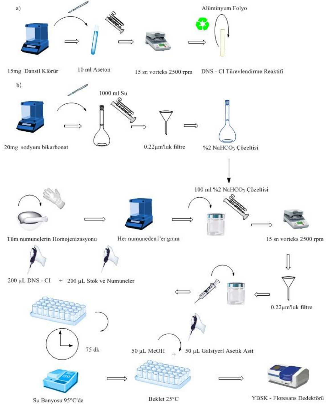
Şekil 4.4. a) DNS-Cl türevlendirme ajanı hazırlanması, b) Numunelerin ve standart çözeltilerin hazırlık basamakları
