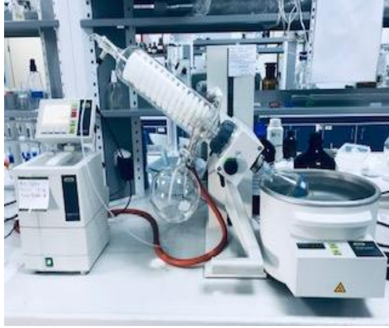
Şekil 3.4. Ekstrelerdeki çözücülerin rotavaporla uzaklaştırılması
