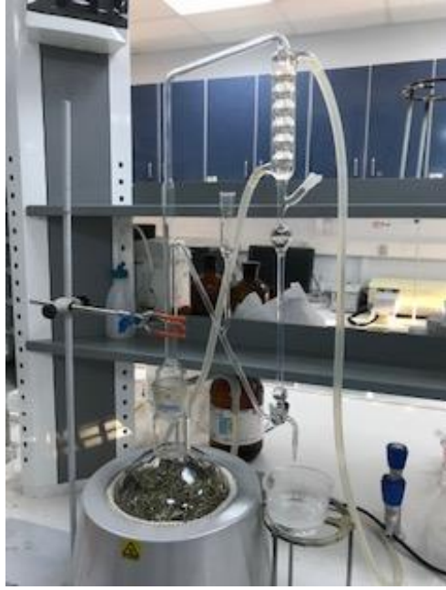
Şekil 4.1. Clevenger apareyinde uçucu yağın elde edilmesi
