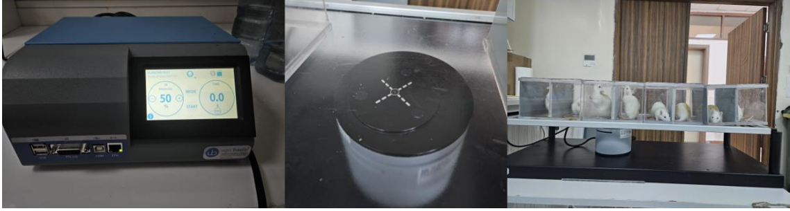
Plantar Test Cihazı (Hargreaves Metot) ve Hayvanların Kafeslere Yerleştirilmesi
