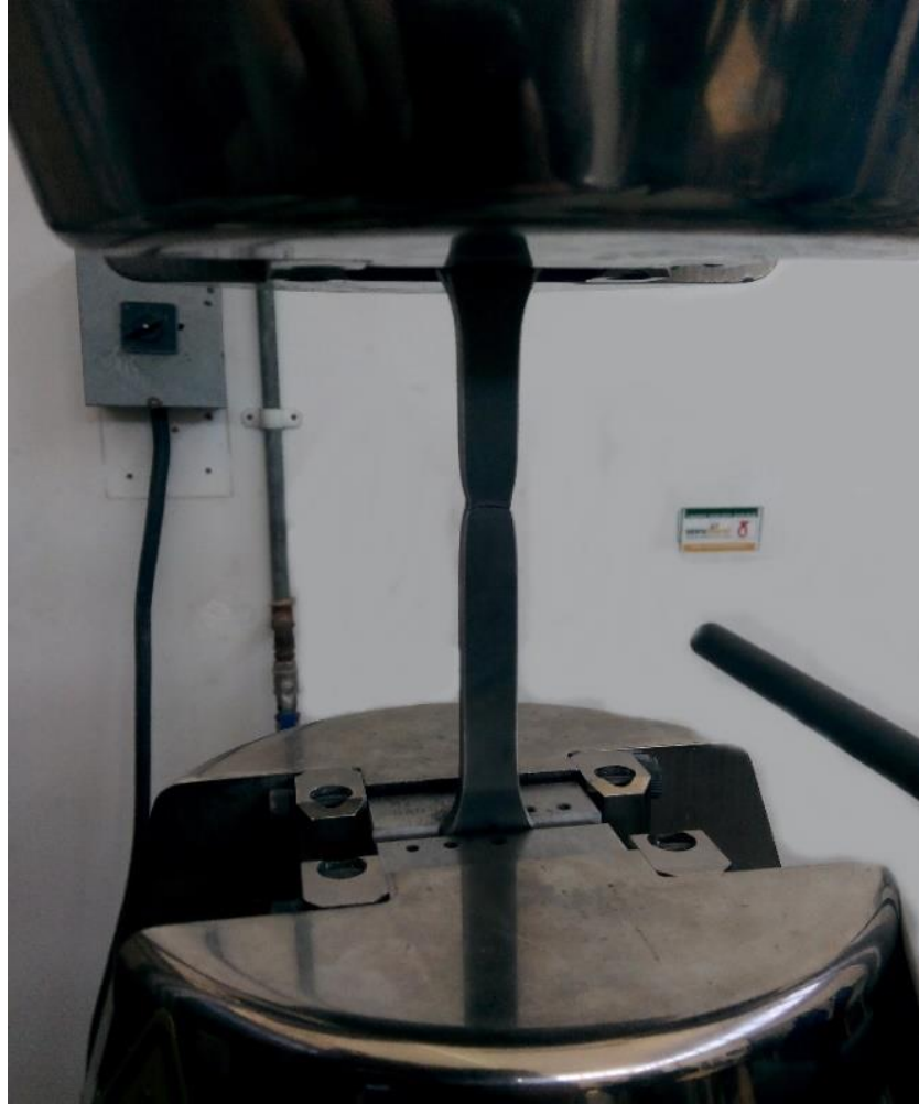
Şekil 4.5. Çekme testi sonucu kopan numune
