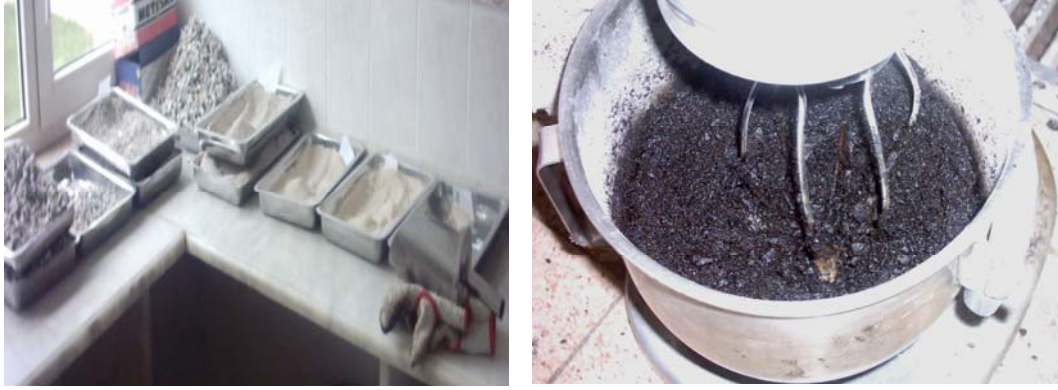
Şekil 5.11. (a) Kullanılan agregalar ve (b) sıcak karışımın hazırlanması
