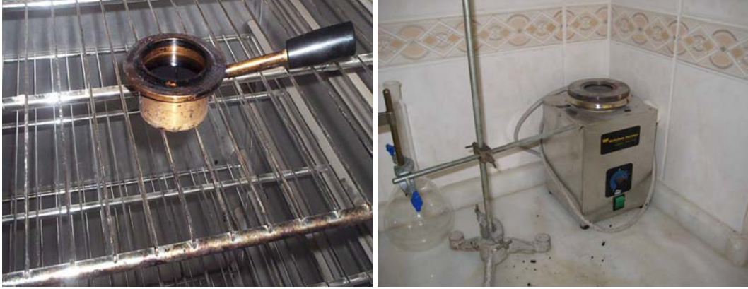
Şekil 5.4. (a) Parlama ve yanma noktası deney numunesi ve (b) deney aleti
