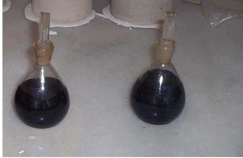
Şekil 5.6. Bitümün özgül ağırlığı deneyi numuneleri
