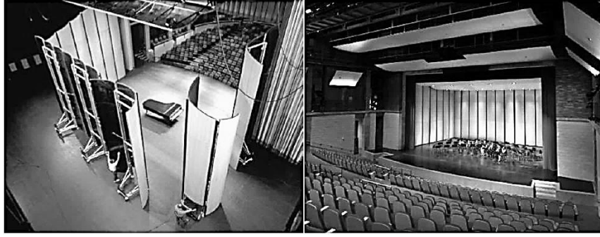
Şekil 2.27. Hareketli orkestra kabuğu örneği; Wenger Corporation, Diva® Full-Stage Acoustical Shells ( http-7 )
