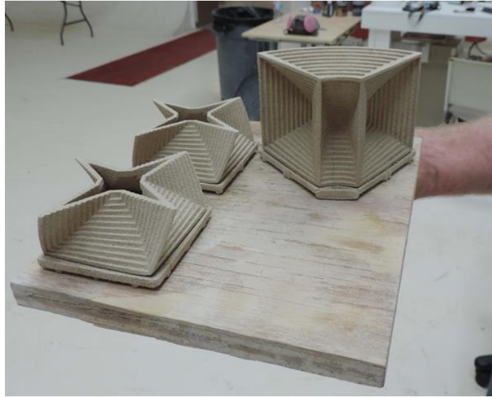
Görsel 3.21. Bisküvi pişirimi için hazır olan formlar, Tethon 3D firması Kaynak: Emre CAN fotoğraf arşivi
