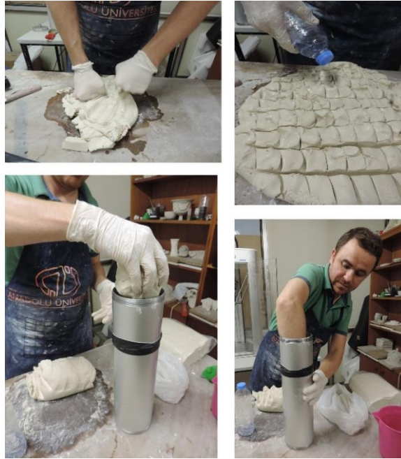
Görsel 4.3. Çamur hazırlama aşaması Kaynak: Emre Can fotoğraf arşivi
