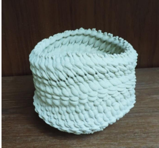
Görsel 3.16. Toz bağlama yöntemi ile şekillendirilmiş form, Tethon 3D firması
