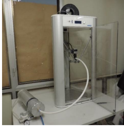
Görsel 3.4. FDM delta tipi üç boyutlu yazıcı 40x20 cm, Delta Wasp, Anadolu Üniversitesi, Güzel Sanatlar Fakültesi Kaynak: Emre CAN fotoğraf arşivi
