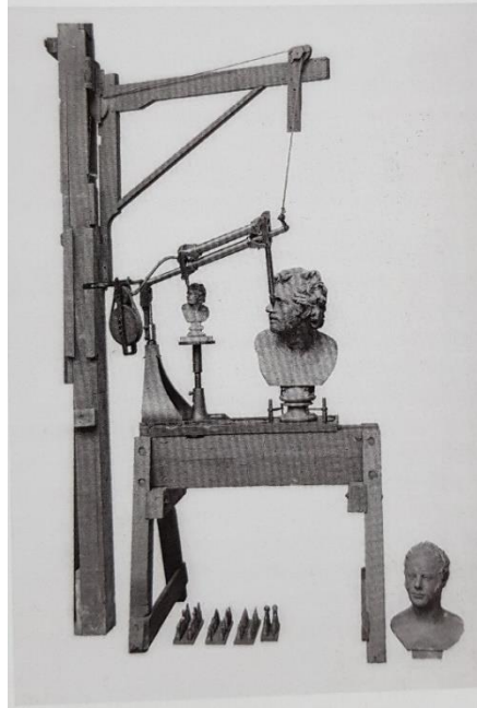
Görsel 2.2 Cheverton'un heykel kopyalama makinesi, 1884 Kaynak: Hoskins, S.(2013)
