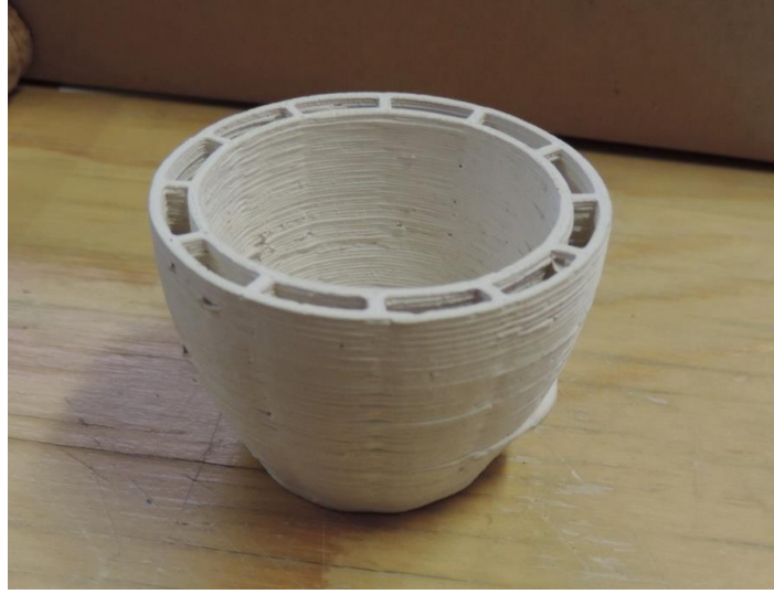
Görsel 3.1. FDM yöntemiyle üretilmiş ilk seramik form, 8x7x7 cm, Unfold, 2009 Kaynak: Emre CAN fotoğraf arşivi
