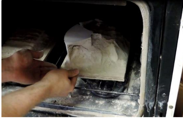
Görsel 3.19. Ürünlerin makineden alınıp etüve konulması, Tethon 3D firması Kaynak: Emre CAN fotoğraf arşivi
