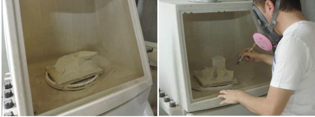
Görsel 3.20. Tozların hava yardımıyla bünyeden uzaklaştırılması, Tethon 3D firması Kaynak: Emre CAN fotoğraf arşivi
