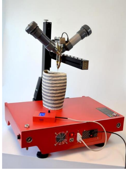
Görsel 3.6. Vorm Vrij firması Kartezyen tipi üç boyutlu seramik yazıcı, Lutum Kaynak: https://3dclayprinting.com/new-lutum-3-clay-3d-printer/
