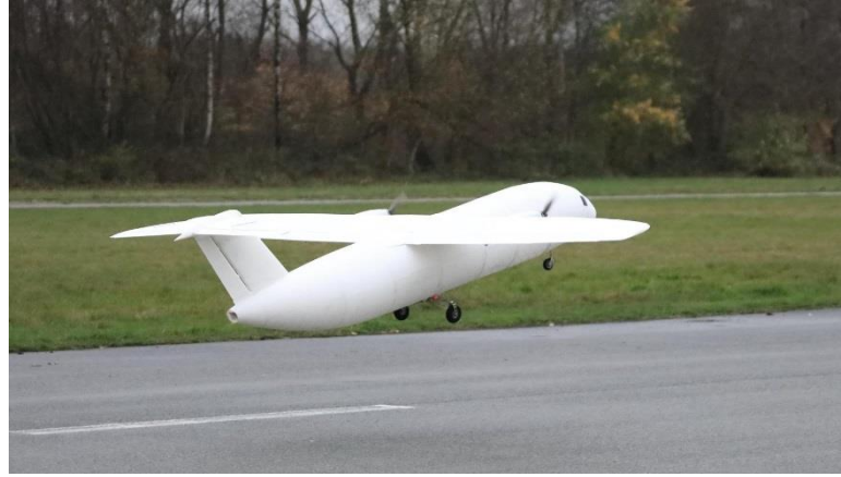
Görsel 2.14. 'Thor' Üç boyutlu yazıcı teknolojisiyle üretilmiş ilk uçak Kaynak: https://qz.com/707849/watch-airbus-made-a-completely-3d-printed-plane-that-actually-flies/
