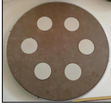
Şekil 5.10. Hazırlanan numunelerin parlatılabilmesi için hazırlanan diskin gösterimi
