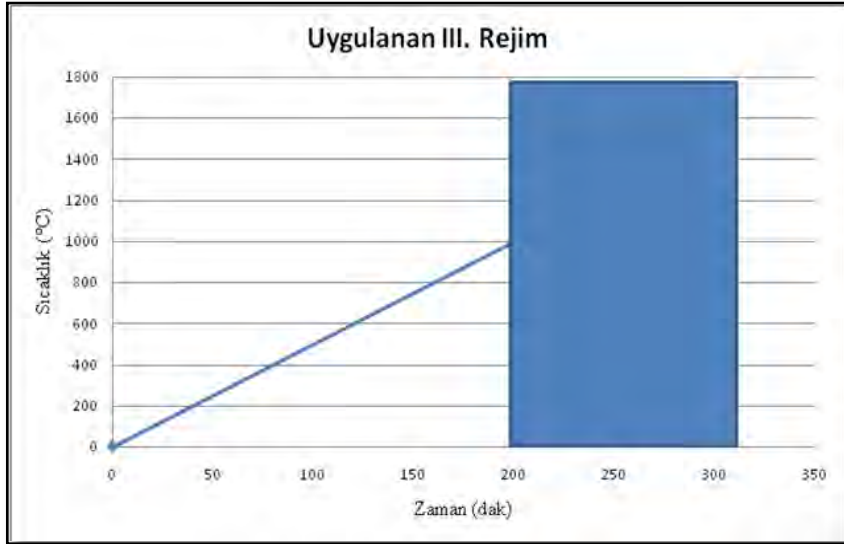
Şekil 3.11.Cai ve ark. tarafından yapılan çalışmada kullanılan 3. Sıcaklık rejiminin gösterimi [62]
