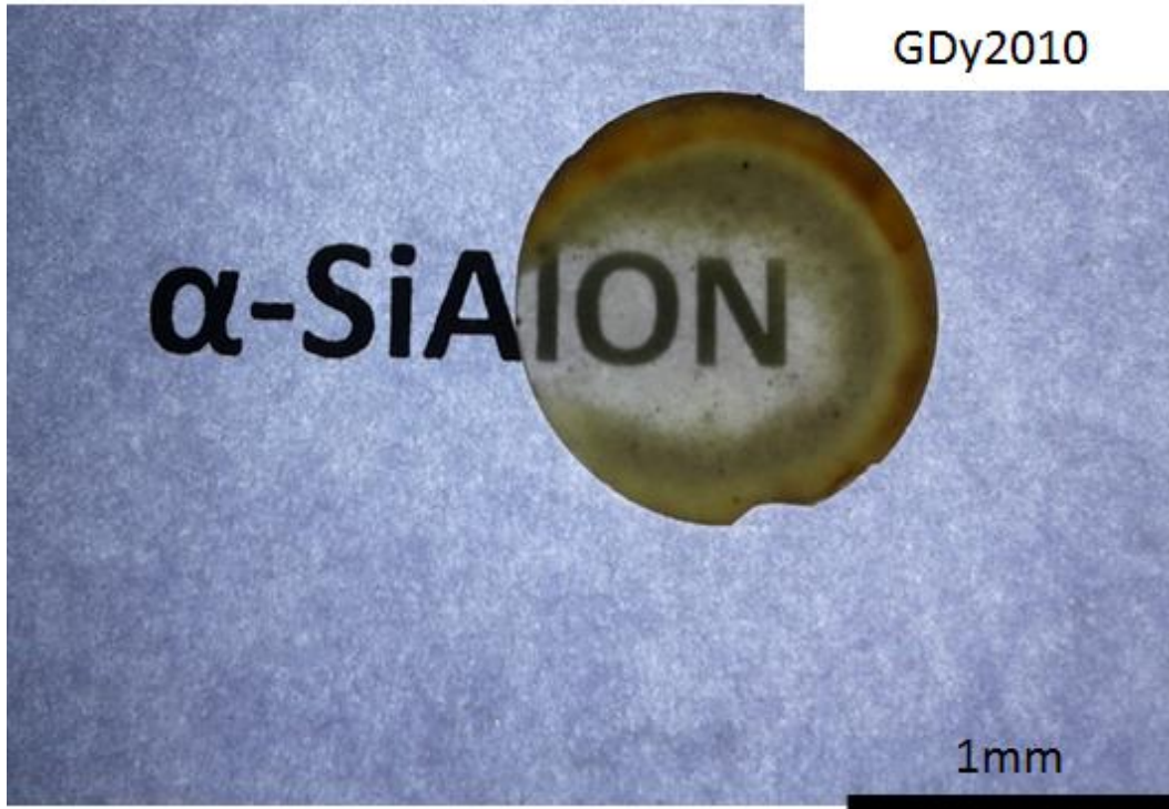
Şekil 5.59. GPS ile sinterlenen 0.3 mm kalınlığındaki GDy2010 numunesinin fotoğrafı.
