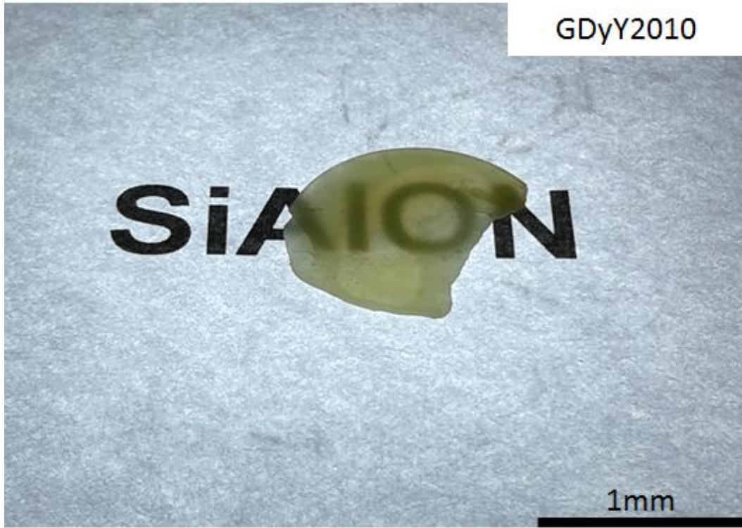
Şekil 5.61. GPS ile sinterlenen 0.3 mm kalınlığındaki GDyY2010 numunesinin fotoğrafı.
