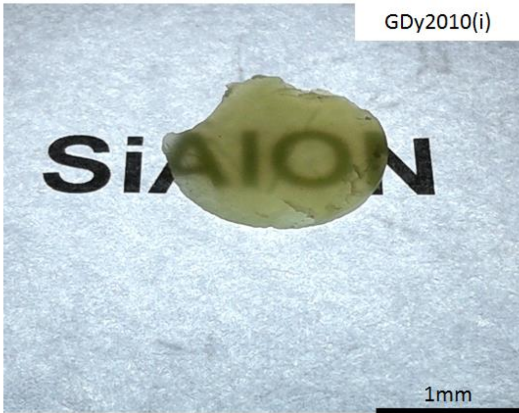
Şekil 5.62. GPS ile sinterlenen 0.3 mm kalınlığındaki GDy2010(i) numunesinin fotoğrafı.
