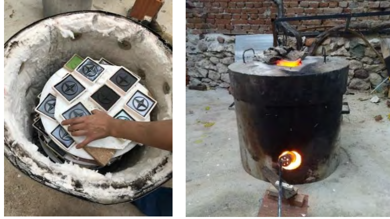
Görsel 3.21. Deneme plakalarının fırına yerleştirilmesi ve redüksiyon pişirimi (Yörük,2020)
