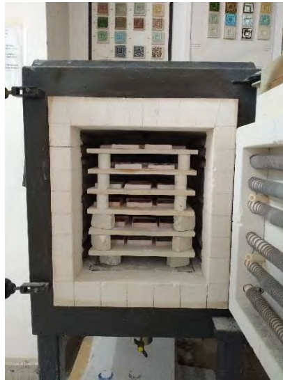
Görsel 3.19. Deneme plakalarının fırına yerleştirilmesi (Yörük,2020)
