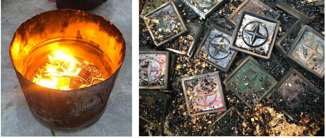
Görsel 3.23. Deneme plakalarına redüksiyon işleminin uygulanması ve sonrası (Yörük,2020)
