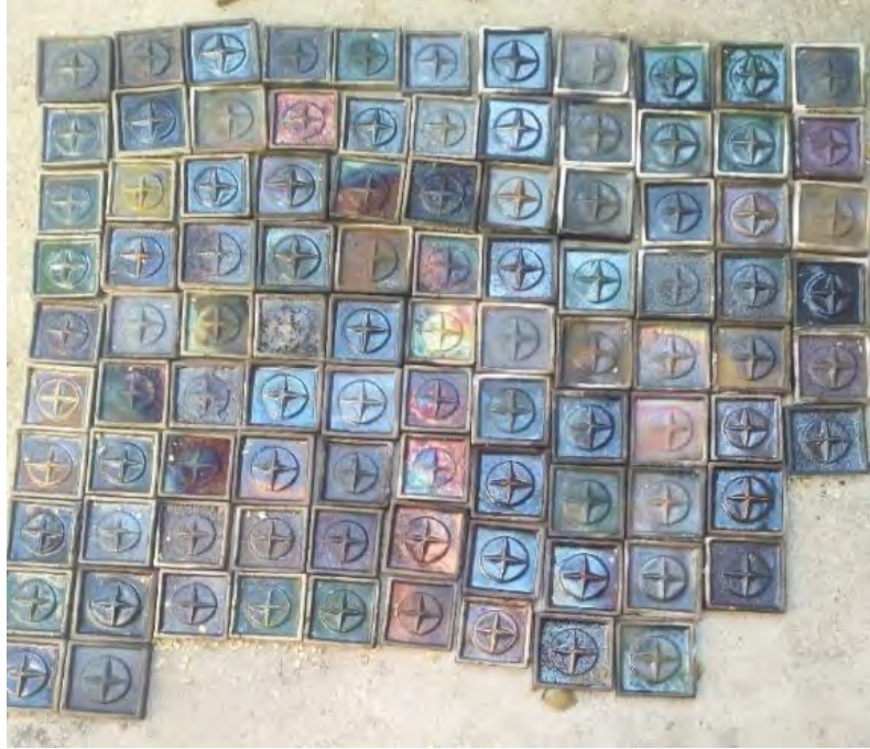
Görsel 3.24. Redüksiyon işlemi uygulanan sır denemeleri (Yörük,2020)
