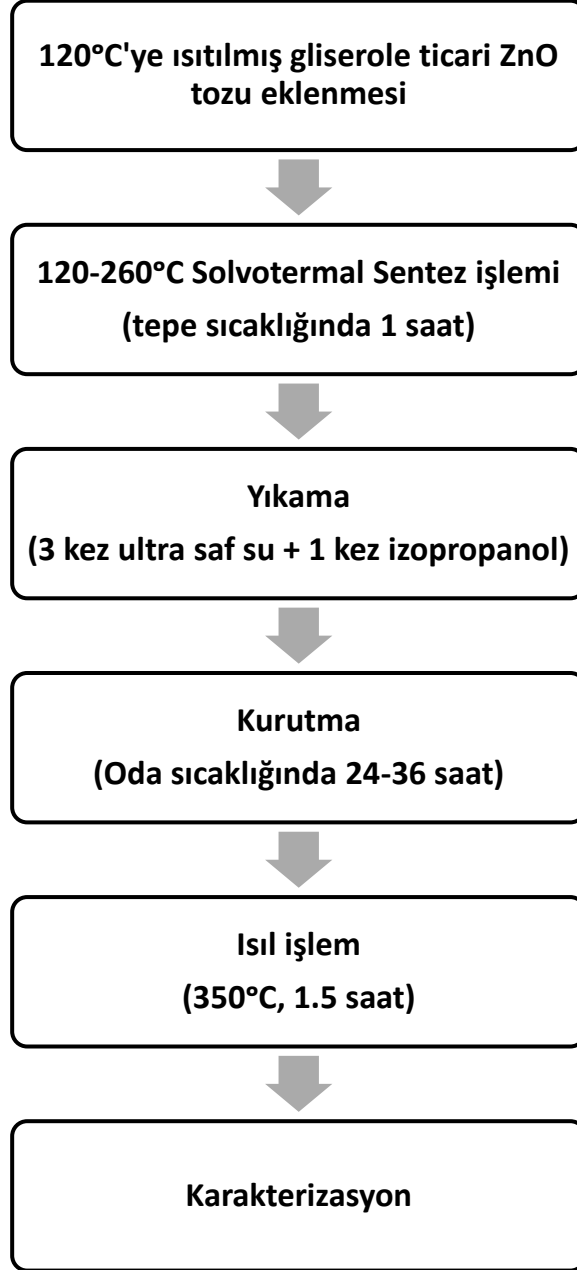
Şekil 5.1. MicNo tozları üretim akış şeması
