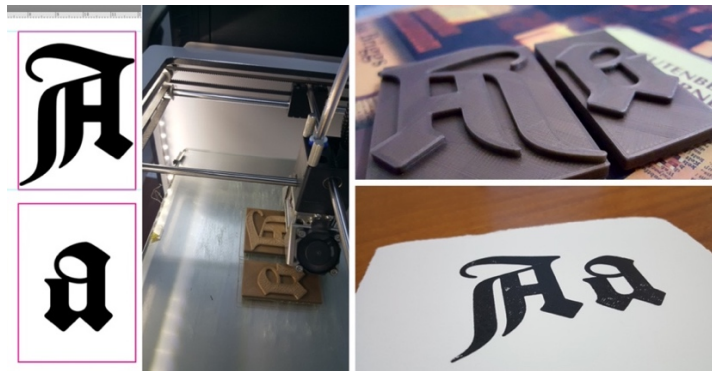
Görsel 2.6. Vektörel olarak çizilen yazı karakteri Textura'nın majiskül ve miniskül 'A' harfleri, 3B yazıcıda yapım aşaması, basımı bitmiş 3B harfler ve 3B harflerle baskı denemesi.
