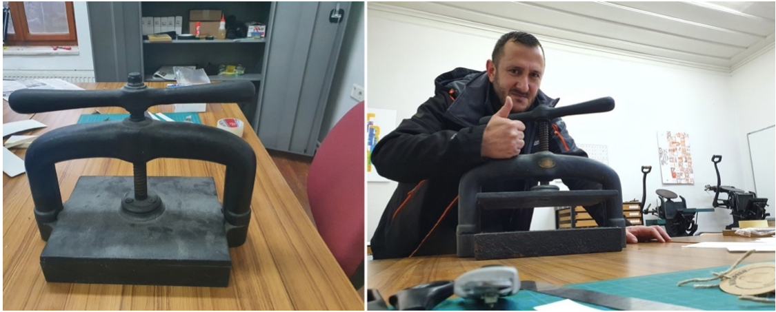
Görsel 4.5. A4 Ofset tarafından atölyeye hediye edilen dökme demir cilt presi. Kaynak: Konur Koldaş Fotoğraf Arşivi (Erişim Tarihi: 20.06.2022)
