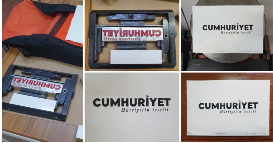
Görsel 4.22. 3 mm. magnezyum klişe kullanılarak yapılan baskı örneği. Kaynak: Konur Koldaş Fotoğraf Arşivi (Erişim Tarihi: 21.06.2022)
