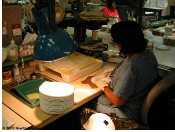
Şekil 2.24 Porselen tabak üzerine çıkartma uygulaması (Neer 2002)
