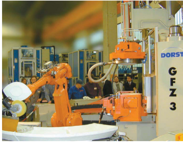
Őekil 2.13. Yuvarlak olmayan formların Őekillendirildięi pres ve rötuřlama sistemi (Dorst 2008).
