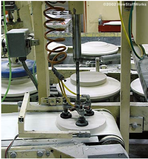
Şekil. 2.6 Tornado tabak şekillendirilmesi (a) Sucuk dilimlerinin kalıp üzerine yerleştirilmesi (b) Kafanın dönerek çamuru şekillendirmesi (Neer 2002).
