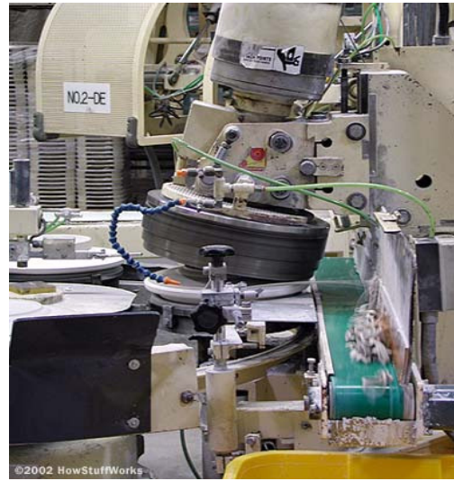
Şekil. 2.6 Tornado tabak şekillendirilmesi (a) Sucuk dilimlerinin kalıp üzerine yerleştirilmesi (b) Kafanın dönerek çamuru şekillendirmesi (Neer 2002).
