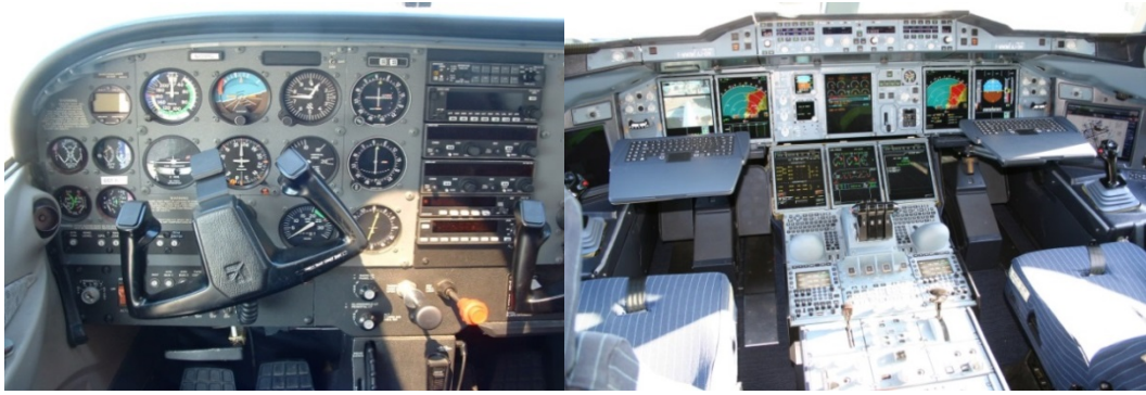
Şekil 1.1. Cessna 172 ve Airbus A380 kokpit panelleri
