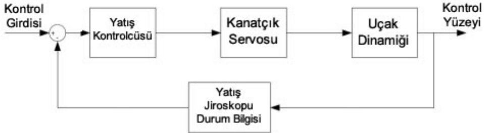
Şekil 4.12. Yanal eksen otopilot blok diyagramı
