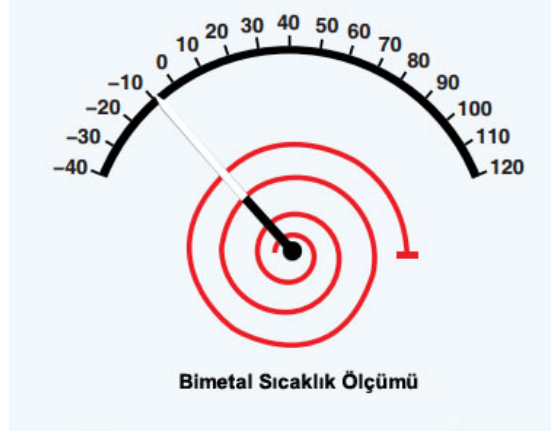
Şekil 2.19. Direkt ölçüm yöntemi ile sıcaklık ölçümü
