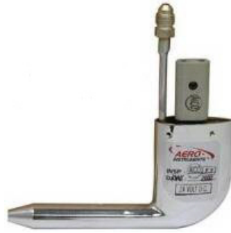
Őekil 2.3. Pitot statik t p 
