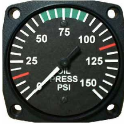
 ekil 2.16. Motor ya  basın  g stergesi
