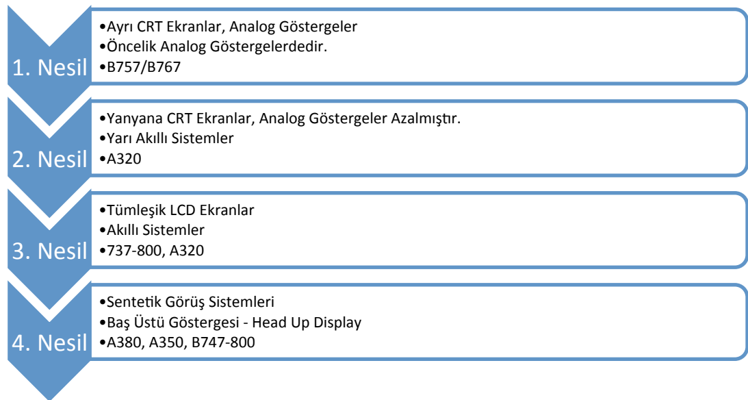
Çizelge 3.1 Elektronik kokpit göstergeleri gelişim süreci
