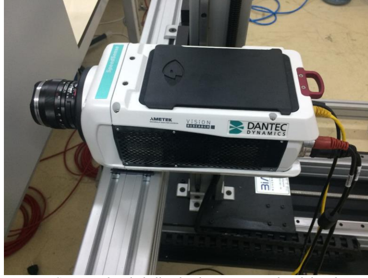
Görsel 4.5. Görüntü almada kullanılan kamera ve üç eksenli hareket sistemi
