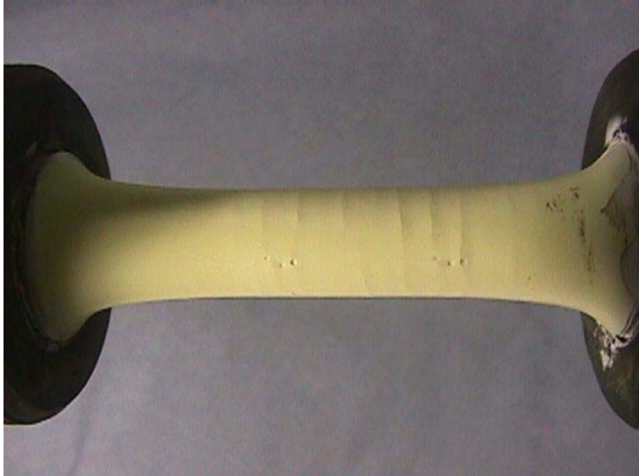
Şekil 2.14. 225000 LCF çevrimi sonrasında A02 numaralı numunenin yüzeyi
