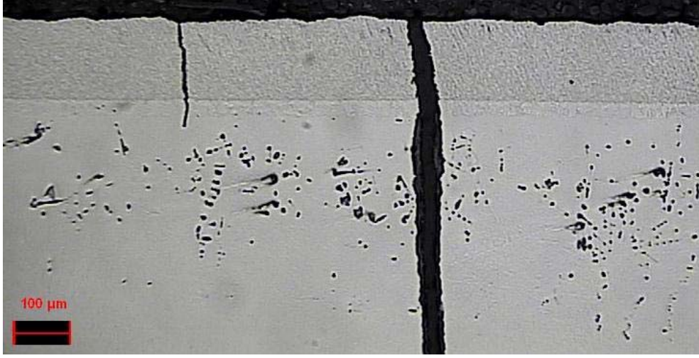
Şekil 2.33. A11 numaralı numune saptanan, numune merkezine doğru ilerleyen bir çatlak
