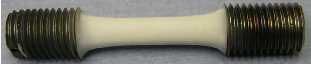
Şekil 2.2. Kaplanmış bir numune
