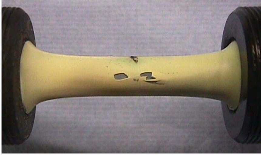
Şekil 2.10. 120000 LCF çevrimi sonrası A01 numaralı numunenin görünüşü
