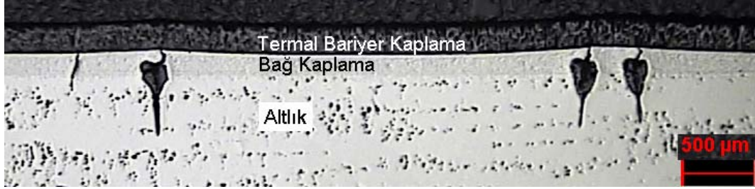
Şekil 2.17. A02 numaralı numunede saptanan seramik kaplamanın altındaki çatlaklar
