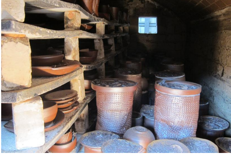
Görsel 35. Fujiwara Kazz'a ait geleneksel Bizen anagama fırınının iç görünümü
