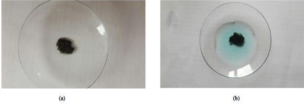
Görsel 3.1. Enzim immobilize edilmiş nanolifin substrat ile etkileşimi. (a) substrat ile etkileşmemiş nanolif (b) substrat ile etkileşen nanolif
