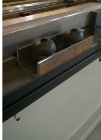
Görsel 3.21. Eksenel yükün yerleştirildiği elastomer takozlar
