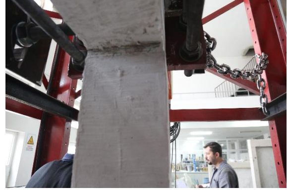
(b) Kolon ve kiriş birleşiminin açılması
