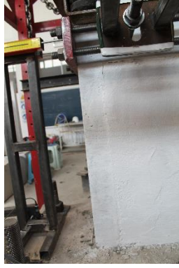
(a) Duvarda gözlenen ayrılma
