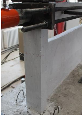
(a) Kolondaki ilk eğilme çatlağı
