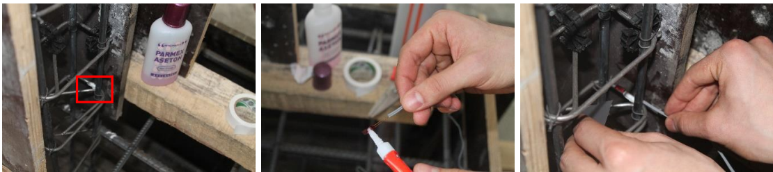
Görsel 3.11. Birim deformasyon ölçerin yapıştırılması
