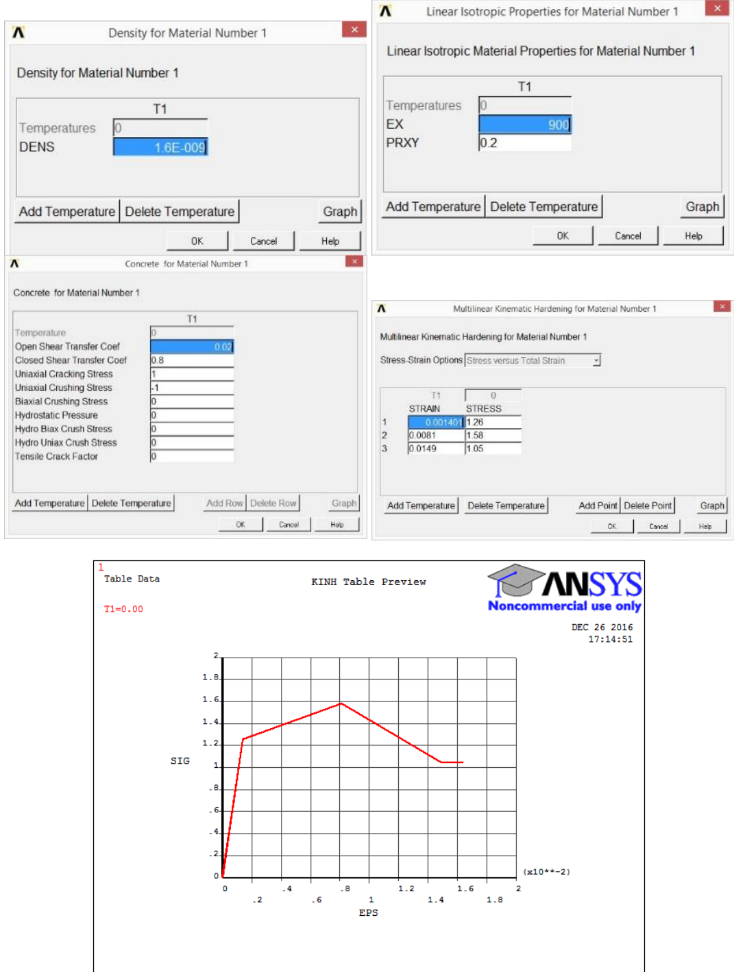
Şekil 6.4. D Grubu için malzeme modeli özellikleri
