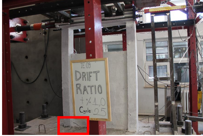
Görsel 4.42. IE09 numunesinde dolgu duvarda gözlenen dönme hareketi başlangıcı
