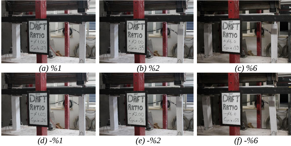
Görsel 4.1. IE01 numunesinin belirli görelî kat ötelemelerindeki durumu
