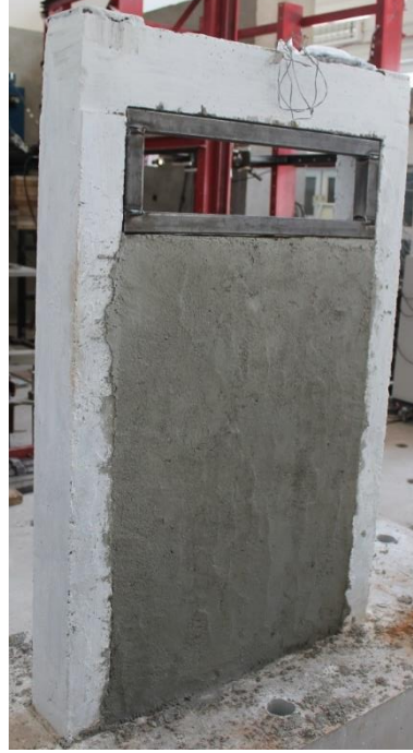
Görsel 4.52. Boşluğa eklenen metal pencere kasası
