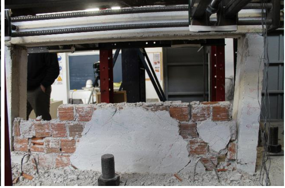
(d) Son çevrimdeki duvar hasarı
