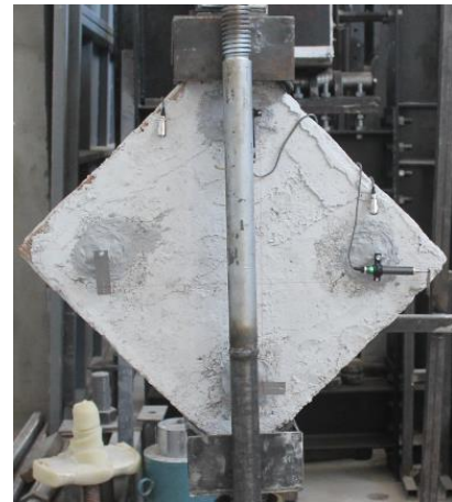
Şekil 6.1. Dolgu duvar modeli ve laboratuvar test görünümü
