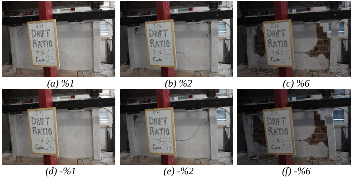
Görsel 4.28. IE13 numunesinin belirli görel kat ötelemelerindeki durumu
