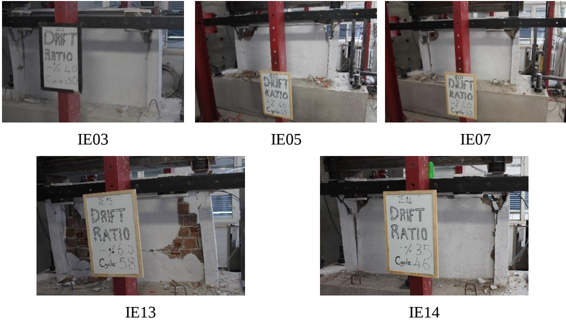
Görsel 7.1. Tam dolu dolgu duvarlı fakat kesme hasarı gözlemlenen numuneler
