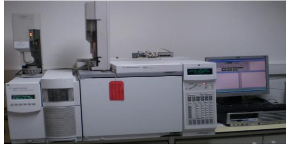
Görsel 3.7. Farmakognosi Bölümü Agilent 5975 GC/MSD Sistemi (1.7.2016)
